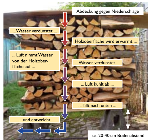
Abbildung 3: Funktionsprinzip der Brennholztrocknung
